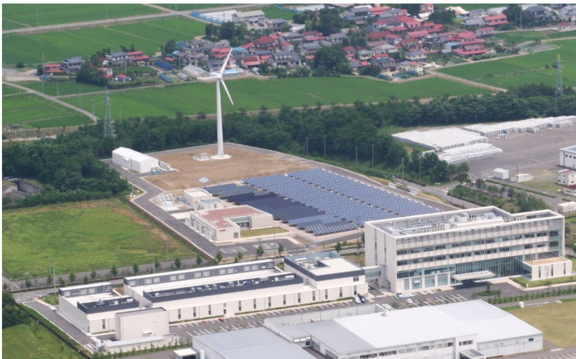
FREA全体の航空写真(2014年7月撮影)。風車および太陽光パネルが見えている部分が実証フィールド。風車は定格出力300 kW、太陽光パネルは全部で2000枚、500 kW。右手前が研究本館、左が実験別棟。
