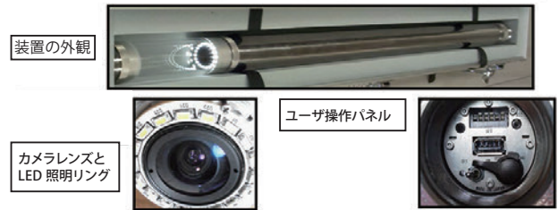
第3図 ボアホールスキャン装置の仕様と外観。
