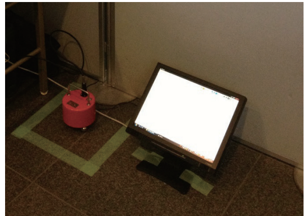
写真2 床に設置した地震計とその記録を表示する液晶モニタ。
