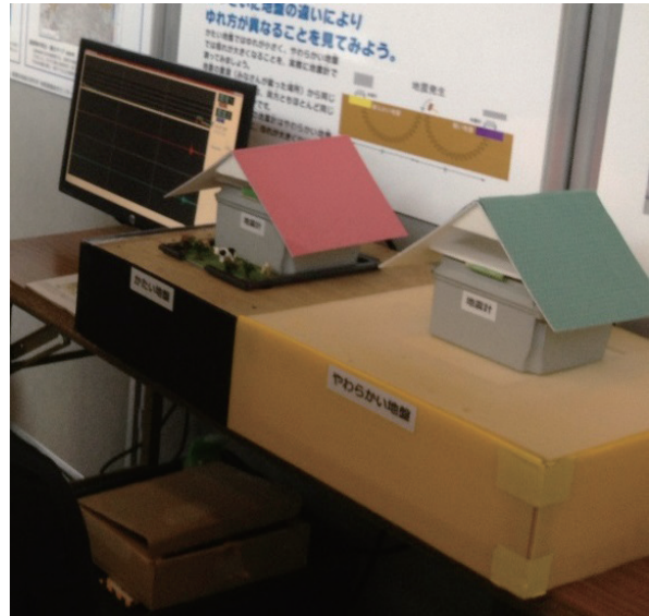
写真1 本展示で用いた地盤模型。左が板でできた固い地盤、右がスポンジでできた柔らかい地盤である。
