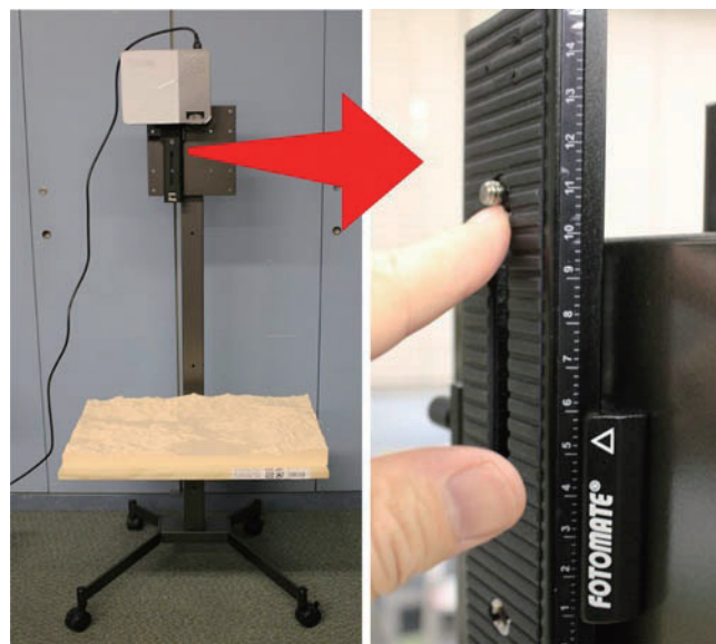
第8図 立体地質模型の投影システム。 左：投影システム全体（大きさはプロジェクター部分も含め高さ約1.5 m, 幅約60 cm）。右：カメラ用スライダを流用したプロジェクターの上下方向への微調整機構。
