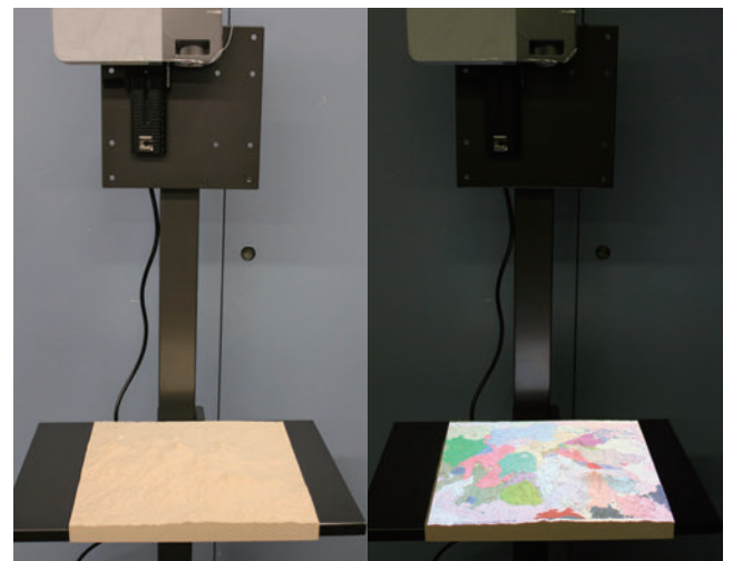
第1図 プロジェクションマッピングを行った霧島火山の立体地質模型（左：投影前、右：投影後）。模型サイズ 290.50 mm × 290.50 mm。なお、投影画像は室内灯が点灯した状態でも視認可能であるが、右側の写真では写真撮影の都合上、室内灯を消灯している。
