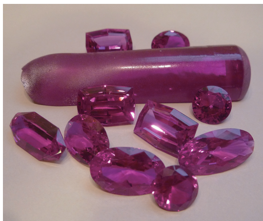
第3図 人工ルビー（中央上）と、同じくカットストーン。 人工ルビーは約6 cm長。カットストーンは、宝石用カット見本として加工されたもの。
