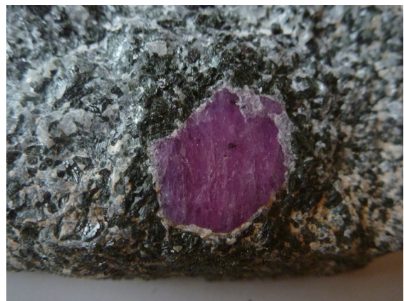
第2図 角閃岩中のコランダム(ルビー)斑状変晶。三方晶系らしい六角板状の結晶。ルビーの径約1.5 cm。ロシア、ウラル産。
