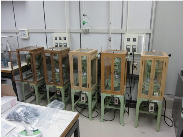
写真2 岩石粉碎室の自動乳鉢。 中央の装置は1964年製で、モーター、スイッチ、上部のカバーはオーバーホール時に交換している。
