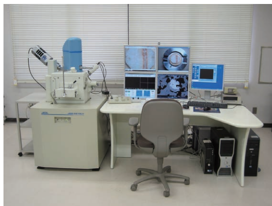
写真2 走査電子顕微鏡 (SEM-EDS-CL) [153室]。 微小領域の電子線像やカソードルミネッセンス像の取得および元素分析・元素マッピングに用いられる (JEOL JSM6610LV)。
