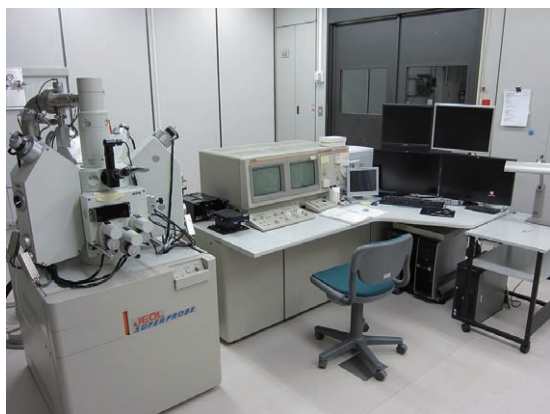
写真1 電子線マイクロプローブ (EPMA) [151室]。 鉱物やガラスの微小領域元素分析に用いられる。 151室に設置されている2台のEPMAのうちの1台 (JEOL JXA-8900)。
