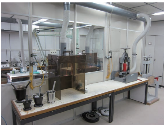
写真11 岩石試料粉碎装置2 [114室]. 油圧式岩石破断器, 乳鉢, 集塵フード. 集塵フードからの排気は室外設置の集塵機に接続されている。粗粉砕側。
