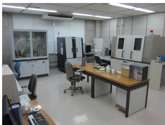
写真6 エックス線回折装置 (XRD) [164室]。 鉱物の同定等に使用される。室内には4台のXRDが設置されている。分析目的により最適な装置が選択できる。
