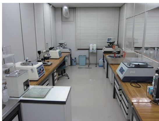
写真4 各種試料研磨設備 [152室]。 EPMA や SEM の分析のための最終仕上げの研磨が実施できる表面研磨装置。
