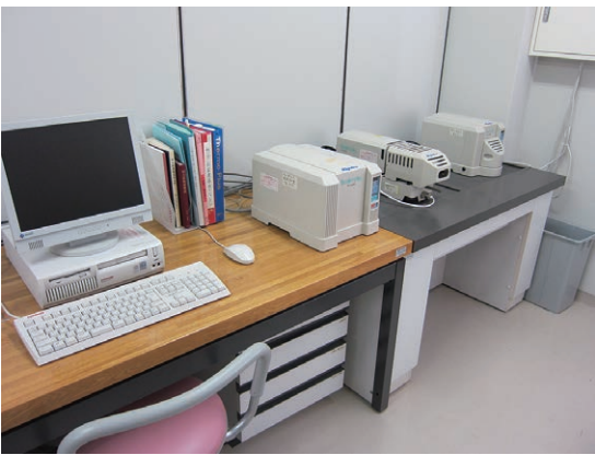
写真9 熱分析装置 [155室]. 3台の熱分析ユニットが設置されているが写真はその内の2台(リガクTG8120/DSC8230)。
