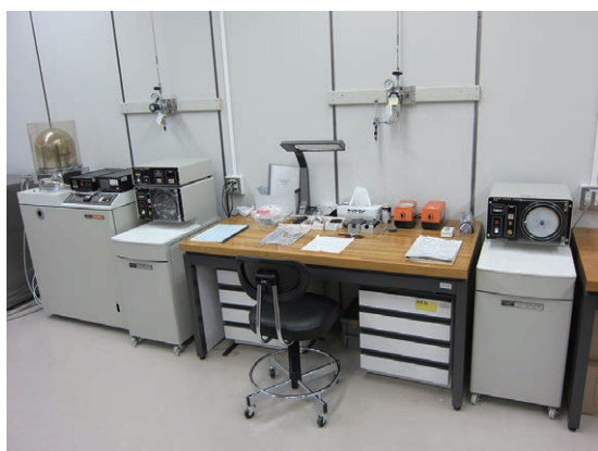
写真3 真空蒸着装置 (炭素蒸着等) [152室]。 EPMA や SEM の分析の前処理用。
