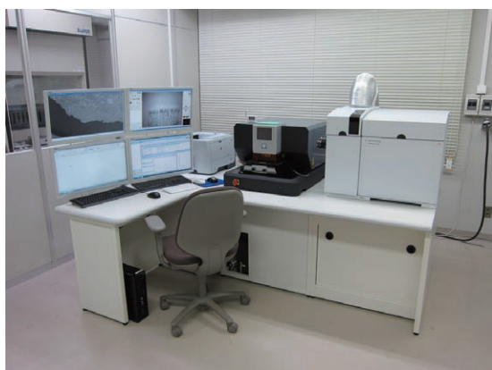
写真5 レザーアブレーション-ICP-MS (LA-ICP-MS) [154室]。 微小領域微量成分分析、土壌等の地質試料やXRF用ガラス円板を分析試料とする全岩微量成分分析に用いられる。
