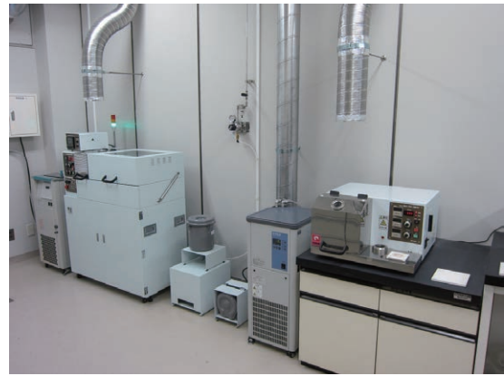
写真8 XRF用試料調製装置(ガラス円板作成装置) [155室]. 全自動と半自動ガラス円板作成装置(東京科学TK-4500,TK4100). 実験室内には電子天秤, 電気炉, オープン, XRF粉末ベレット用油圧プレス装置が含まれる。
