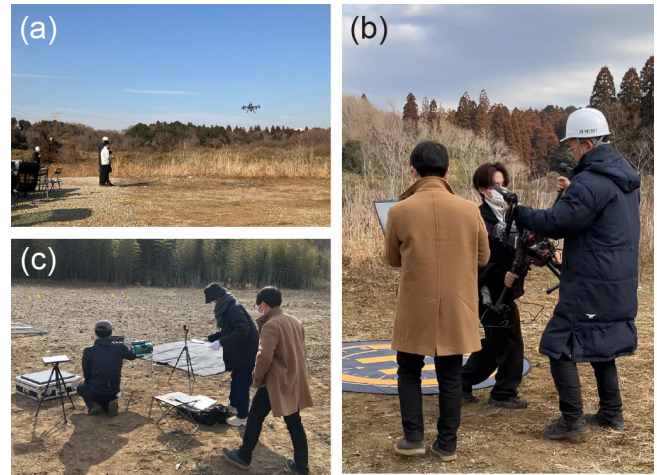
第3図 (a) ドローン実証試験飛行中の様子。(b) 飛行前のハイパースペクトルセンサのコンパスキャリブレーションの様子。センサをパソコンに繋ぎながらドローンごと姿勢を変えながら動かす。(c) 地上観測機器を設置している様子。
