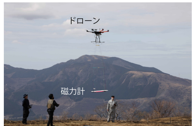
第2図 無人航空機(ドローン)による磁気探査の様子。※原論文の図を引用・改変したものを使用しています。
