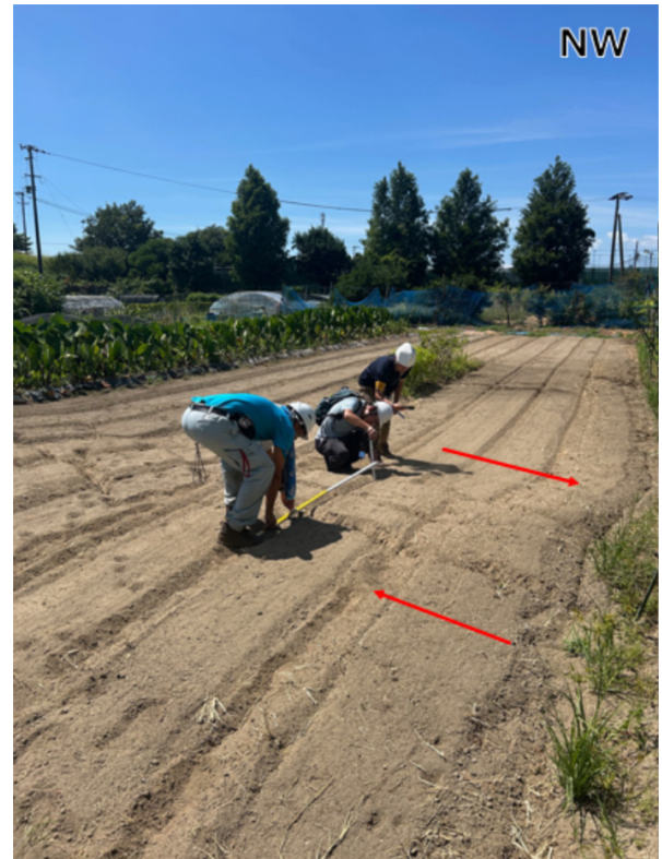
写真13 熊本市渡町の畑内に見られる右横ずれ変位。右横ずれ変位量25 cm, 上下ずれ変位量17 cm 北西低下。写真は北西方向に向かって撮影（2026年7月31日撮影）。
