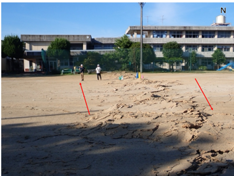
写真10 熊本県八代市岡町の八代市立龍峯小学校の校庭に見られる右横ずれ変位とずれによって生じたモールトラック。校庭に引かれていた白線を基準にした時の右横ずれ変位量は94 cm。写真は北方向に向かって撮影 (2026年7月31日撮影)。
