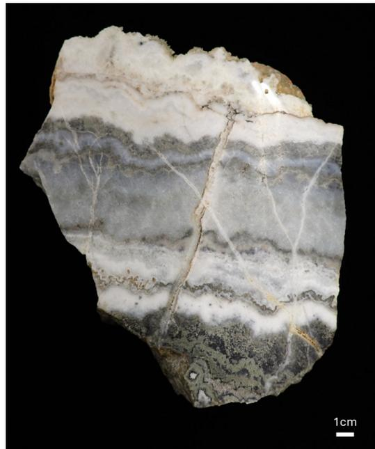
写真3 含金銀石英脈試料(切断面)の展示(北海道・光竜鉱山3号脈)。縞状の黒色部に金や銀が含まれる。
