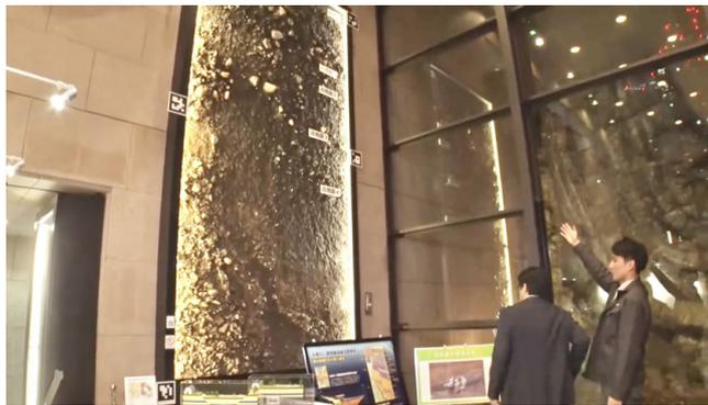
写真5 活断層トレンチの剥ぎ取り標本(近藤, 2014; 近藤・谷口, 2014)。糸魚川-静岡構造線活断層系の一部、岡谷断層のトレンチ調査で採取した高さ4.5mの剥ぎ取り標本。約7,200年前以降に発生した4回の古地震イベントによる変位を記録している。
