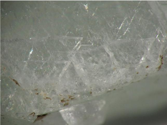
第10図 蛍石：岐阜県平岩鉱山(地質標本館登録標本:GSJ M41596)。蛍石のへき開面。へき開面上には別方向のへき開面との交線が3方向認められ、それらにより三角形の様子が観察できる。図の長辺は約5.8mm。
