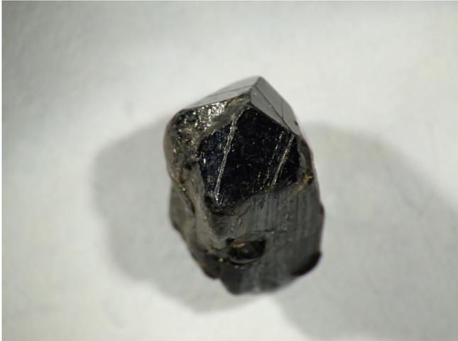
第 13 図 錫石：京都府鐘打鉱山（地質標本館登録標本：GSJ M20048）。錫石の分離結晶。正方柱状を示し、結晶の伸びの方向から見ると正方形に近い形が観察できる。図の長辺は約 1.5 cm。
