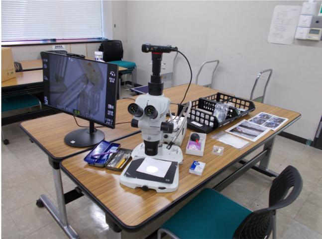
第5図 研修で使用した実体顕微鏡一式。観察部分をモニターに表示して結晶の形やへき開の特徴等を研修者に示すことができる。
