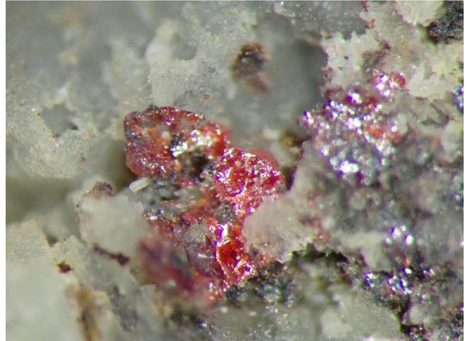
第 15 図 淡紅銀鉱：栃木県西沢鉱山（地質標本館登録標本：GSJ M24673）。淡紅銀鉱結晶の破断面。透明でありつつ金属的な光沢を持ち、深い赤色を示す。図の長辺は約 2.0 mm。
