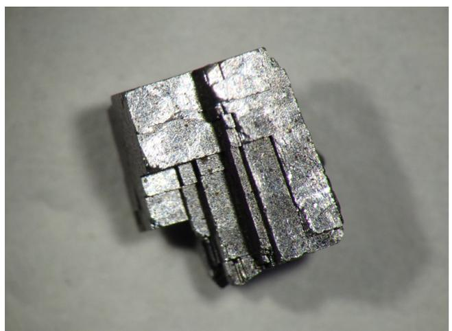
第8図 方鉛鉱：宮崎県土呂久<sup>とろく</sup>鉱山。方鉛鉱のへき開片。閃亜鉛鉱(第1図)とは異なりサイコロ状に割れる(へき開面同士が直交する)ことが特徴。図の長辺は約7.3 mm.
