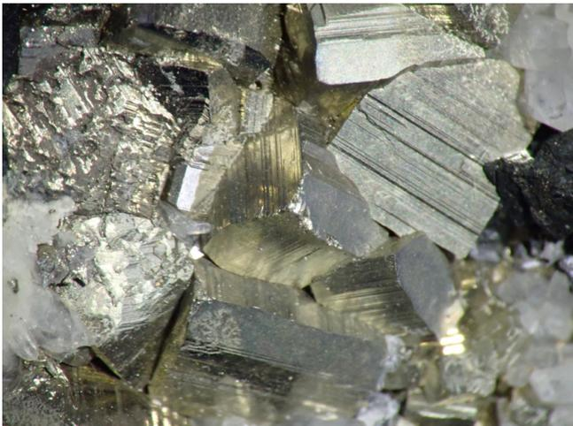
第6図 黄鉄鉱：青森県尾太<sup>おつぶ</sup>鉱山(地質標本館登録標本:GSJM20980)。サイコロのような形(正六面体)の結晶を示す黄鉄鉱。結晶面上に条線が観察できる。隣り合った面では条線の方向が異なる(直交する)ことに注意。黄鉄鉱は結晶を示すことが多い。図の長辺は約1.5 cm.
