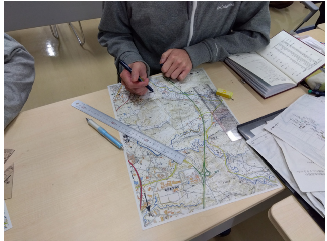
写真4 夜の調査データ整理の様子(地層境界線の作図) 土ヶ目木ルートの調査データをまとめた後、このルートで確認できた地層境界線が南側の長畑北方の沢ルートでどのように出現するかを予測する図を作成し、翌日の調査計画を練っていく。長畑北方の沢の調査で地層境界の位置が確認できたら、地層境界線の修正をして、地質図を作成していくことになる。 第1回の研修3日目(5月17日;広野町公民館の研修室)
