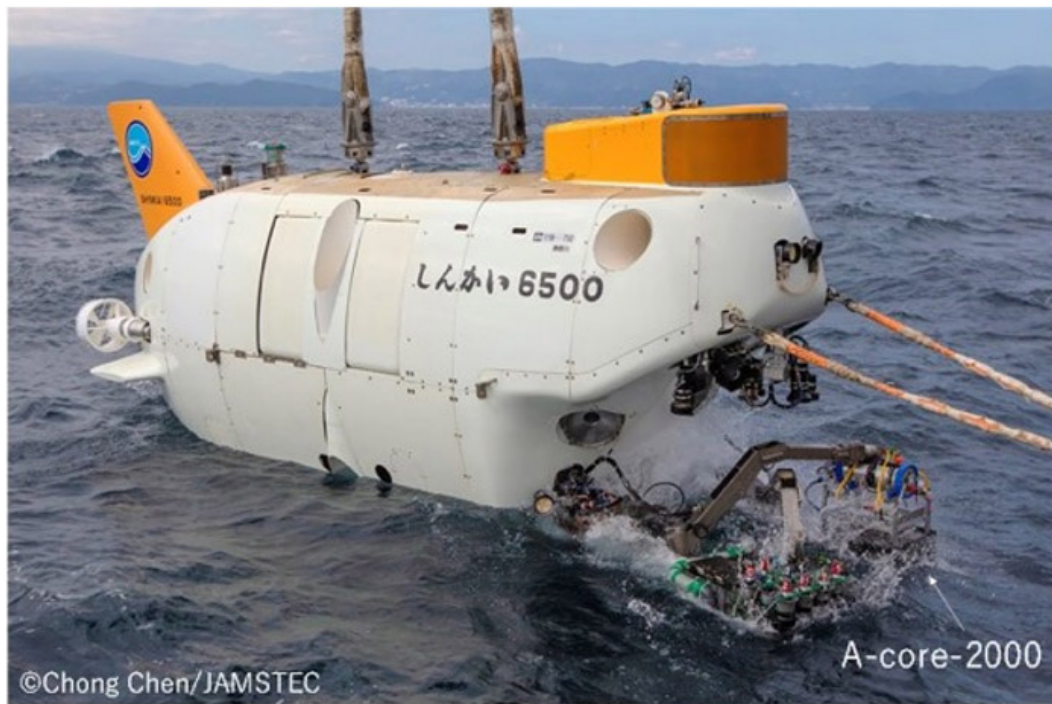
第3図 しんかい 6500 に搭載された A-core-2000。右下の矢印で示した場所に搭載されている。
