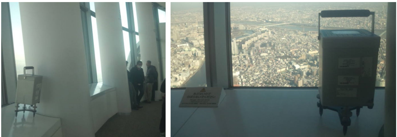
写真 1 東京スカイツリー天望フロア 350 での CG5 重力計による計測風景。
