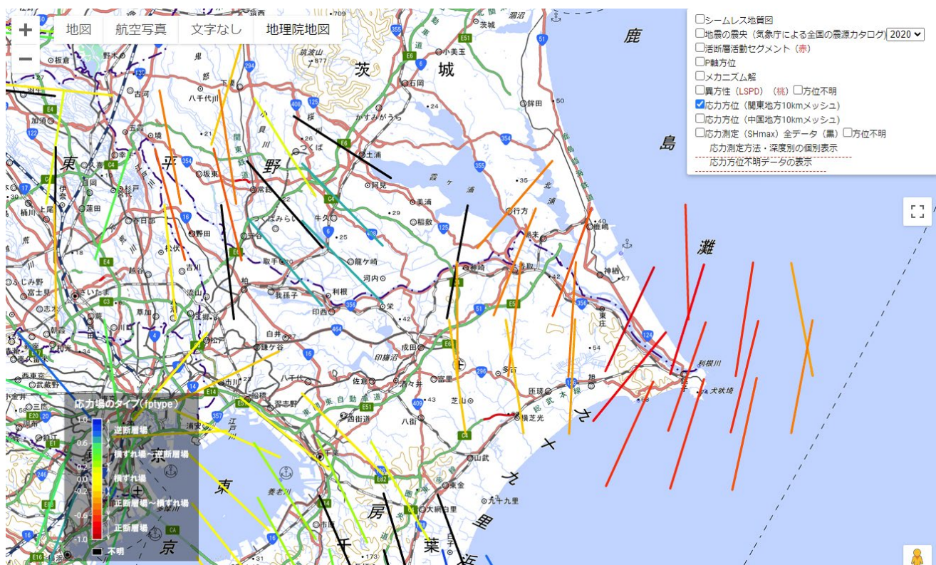
第1図 地殻応力場データベース：直線は10 km メッシュ内の水平最大主応力 (SHmax) の向きを表し、色は応力場を示す。 https://gbank.gsj.jp/crstress/ より
