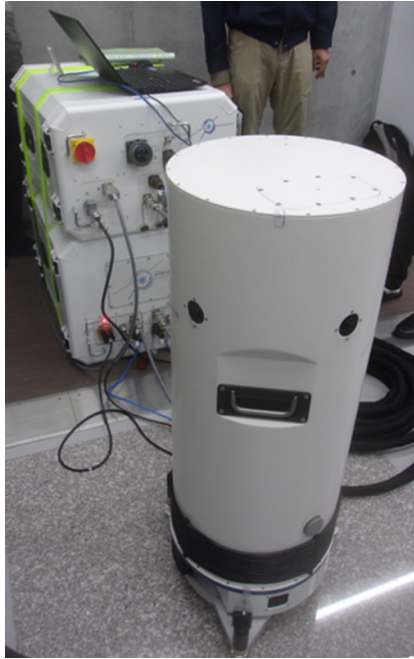
第3図 量子型絶対重力計 AQG 本体部分の写真とイメージ図。写真の左奥は AQG のコントローラ部分。
