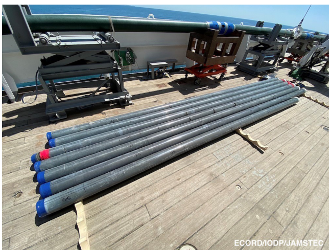
写真4 コアは本体コアラーステムから抜き出され、5 m 毎のセグメントに分割される
