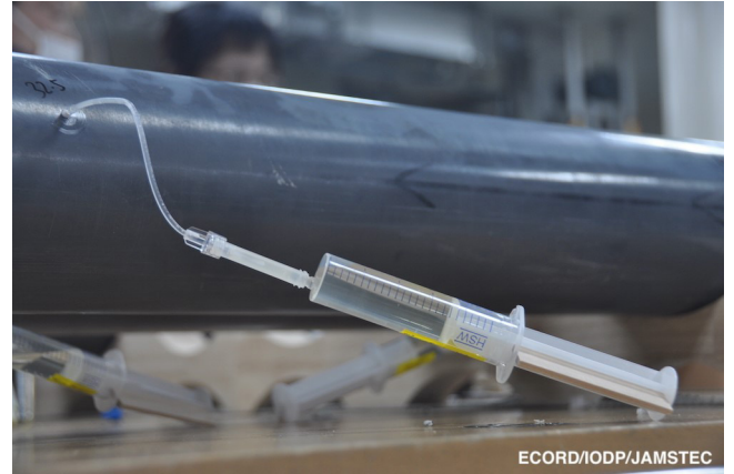
写真8 実験室では間隙水のサンプリングが行われる
