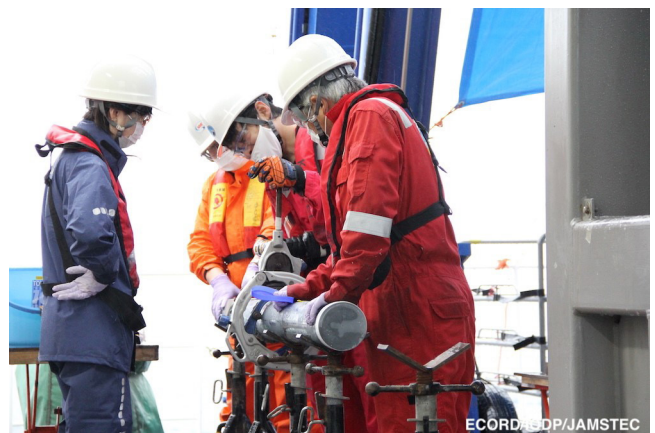
写真5 5 m のセグメントは1 m 毎のセクションに分割される
