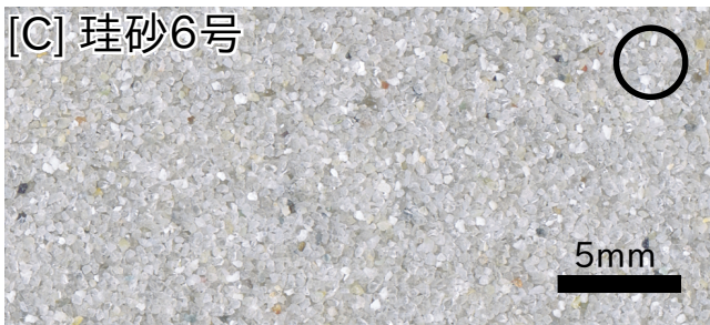
[C] 珪砂6号 新しく導入。崩壊しない様に角張った珪砂にした。
