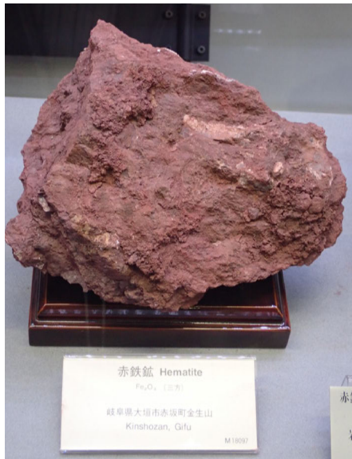
第14図 風化残留鉄床の例 岐阜県大垣市金生山産の赤鉄鉱 (1階第4展示室)
