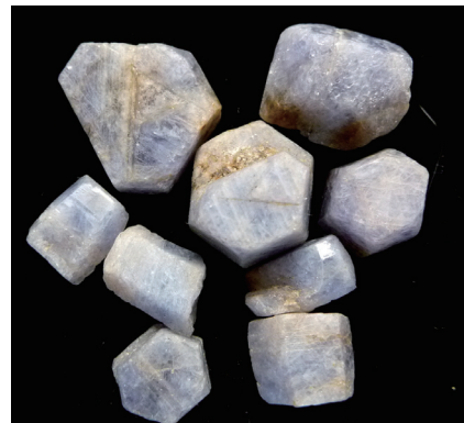
第2図 ブルー・サファイアの結晶。マダガスカル産。中央の個体のような六角板状ないしは、中途が膨れ気味の短柱状の結晶になる。六回対称軸をもつ六方晶系ではなく、一段対称性の低い三方晶系であることが、左上の個体の形から分かる（この個体の径が約1.5 cm）。本品は色が淡すぎ、傷等のために透明度が低く、宝石質ではない。
