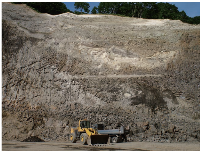
第 14 図 地点⑧の安山岩採石場. 柱状節理の発達した安山岩岩脈, スランプ堆積物, 凝灰角礫岩など.
