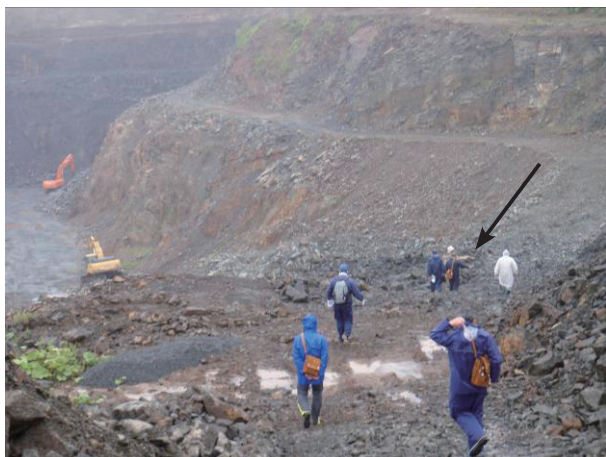
第 13 図 浜中駅北東方の採石場（第 3 図の地点 7）。 泥岩主体の太田村層下部層に貫入している石英モンゾ ニ岩を採取している。矢印は粗粒玄武岩の露頭。
