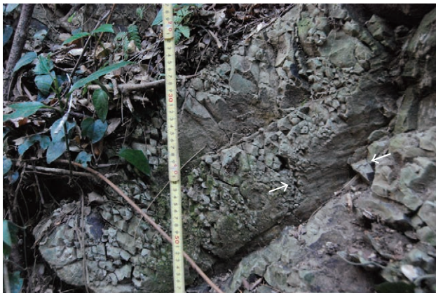
第4図 角礫状の断層ガウジ。 Fig.4 Fault gauge as fault breccia.
