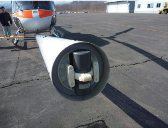
第 3 図 セシウム磁力計センサー (大熊・中塚, 2013). スティンガー先端部に設置されたセシウム磁力計センサー. 写真のように円柱状センサーの長軸部を鉛直方向にして設置する.
