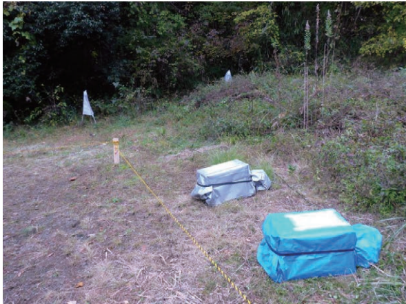
第6図 地磁気日変化観測装置。 ビニールシートで覆われたアルミ製トランク内にプロトン磁力計本体が収納されている。欠測を防ぐため2台設置して観測している。写真奥の半透明のビニール袋で覆われたのはプロトン磁力計センサー。
