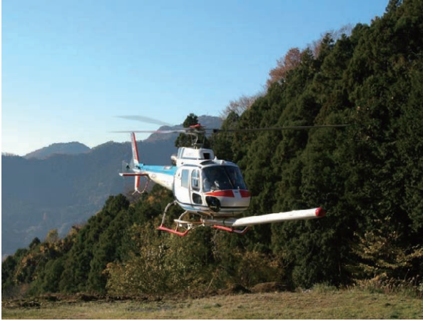
第 2 図 空中磁気探査調査ヘリコプター (中日本航空 (株) 所有). AS350B3 型機. 機体下部にスティンガーを固定し, その内部に Cs 磁力計センサーおよびプリアンプ, フラックゲート型磁力計センサーを収納する. 撮影場所: 神奈川県伊勢原市子易場外ヘリポート.
