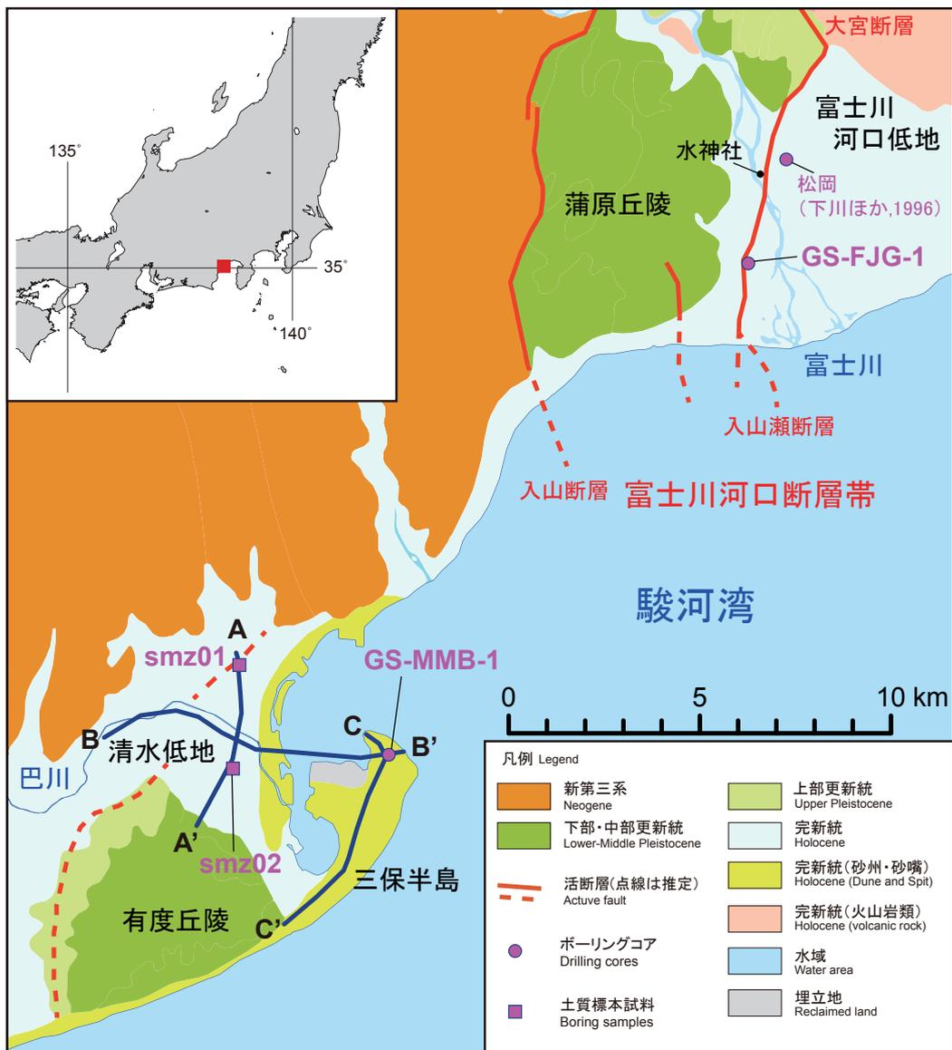
第 1 図 駿河湾奥部の地質図とボーリング掘削地点，土質サンプル地点，地質断面図の位置（第 4～9 図）。地質図は産業技術総合研究所地質調査総合センター（編）（2012）を簡略化。新第三系，下部・中部更新統，上部更新統の地質をそれぞれ一つの凡例に統合した。活断層の位置は静岡県（1996），中田・今泉（2002），杉山ほか（2010）より引用。
