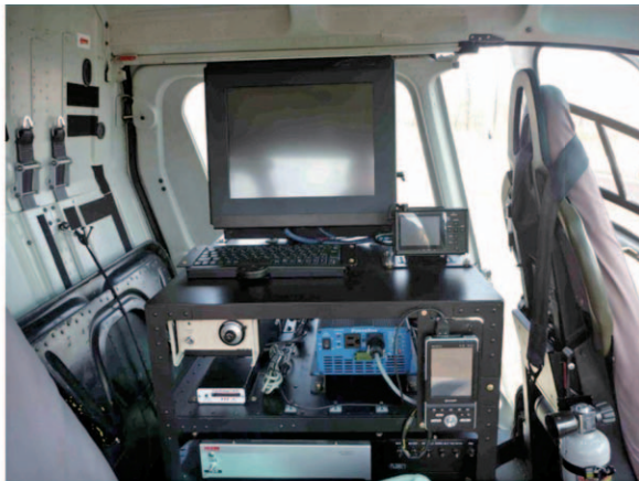
第 6 図 機上データ収録装置 (1) (大熊・中塚, 2013) ラック最上部には、キーボード、15 インチ液晶ディスプレイおよび対地ビデオ収録装置が置かれている。ラック内は三段で、最上段に気圧高度計本体、GPS のデータロガーおよび同操作用の PDA が電源と一緒に置かれていたが、最新システムでは装備品とその配置が変更される予定である。中段にはセンサーカプラーが、最下段には収録部のラックマウント PC が設置されている (第 7 図参照)。
