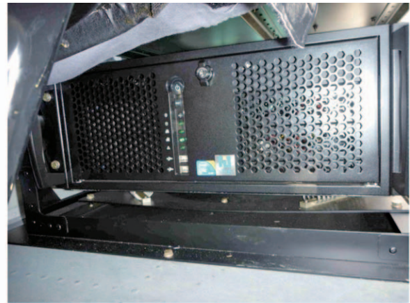
第 7 図 機上データ収録装置 (2) (大熊・中塚, 2013) 収録部のラックマウント PC (HPC Systems HPC1000-CD104R4)。MS Windows で動作。PCI 規格の A/D 変換ボード PCI-1718HDU-AE (アドバンテック (株)) と周波数カウンタボード GT210PCI-8 (GuideTech, USA) を内蔵する。
