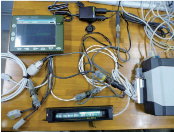
第 4 図 機上ナビゲーション装置 左上が本体 (AGNAV 社 LiNav)。中央下がパイロットインディケータ。Way point の入力や航跡の表示などを行い、調査飛行中はナビゲータが操作する。 右端は GNSS 装置 (Novatel ProPak 6)。
