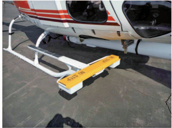
第 5 図 電波高度計 (中日本航空 (株) 所有) (大熊・中塚, 2013) 電波高度計の送受信アンテナ。スキッドのステップ先端部分に取り付けられている。アンテナ間の中央部には対地ビデオカメラの CCD センサーが取り付けられている。
