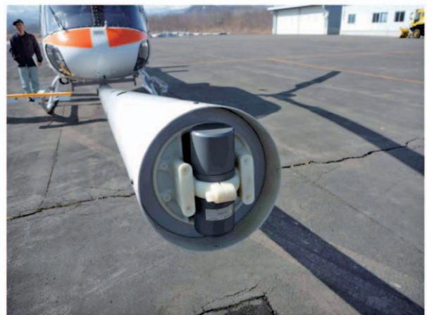
第 3 図 セシウム磁力計センサー(大熊・中塚, 2013) スティンガー先端部に設置された Cs 磁力計センサー。写真のように円柱状センサーの長軸部を鉛直方向にして設置する。 Fig. 3 Sensor of CS2 Cesium magnetometer (Okuma and Nakatsuka, 2013). A Cs magnetometer sensor is located at the point of the stinger. The sensor is oriented as its major axis is vertical.
