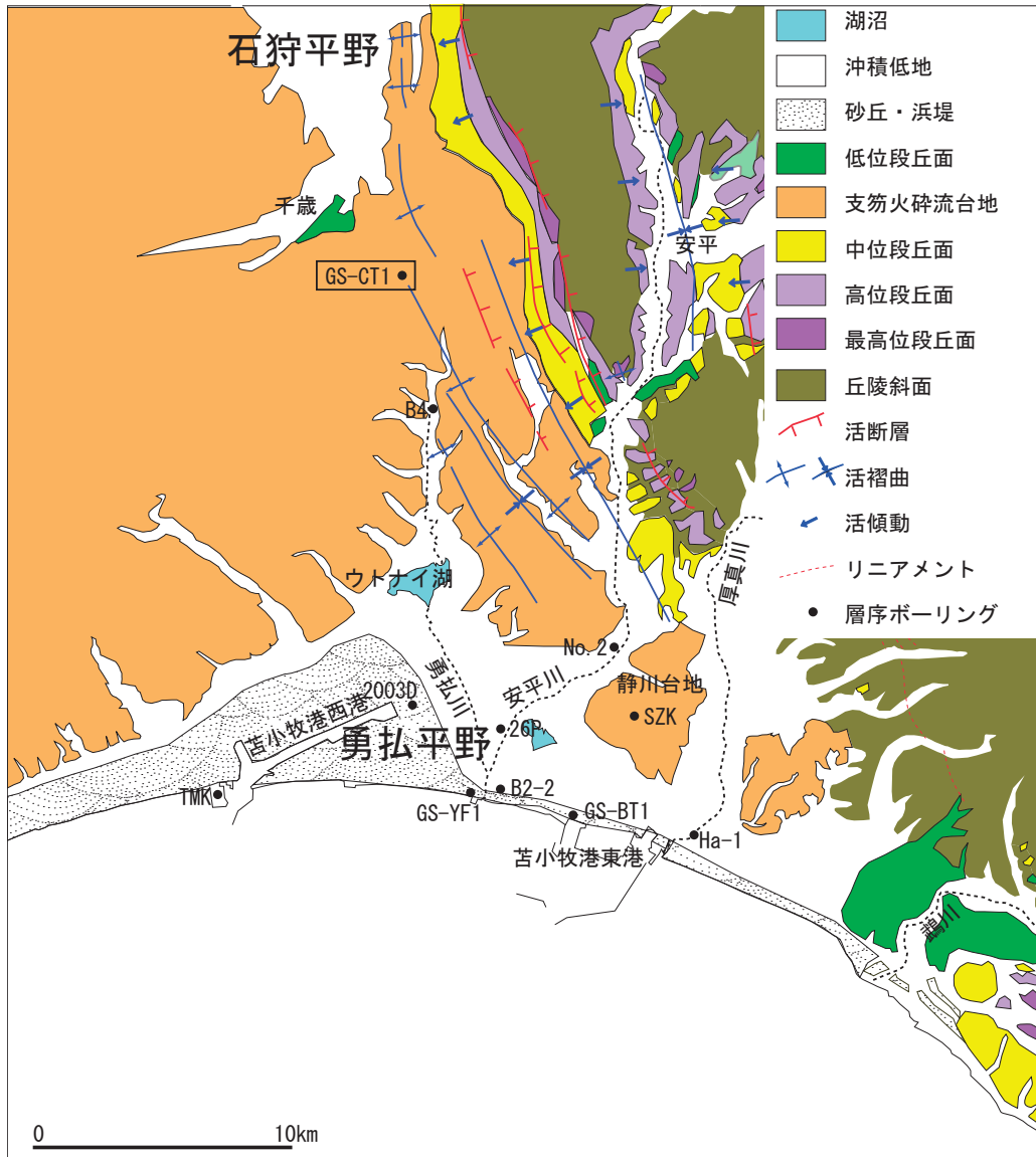
第 1 図 ボーリング掘削地点と既往層序ボーリングおよび地形分類。 Fig.1 Location of the drilling site, former stratigraphic drilling sites and geomorphological classification.
