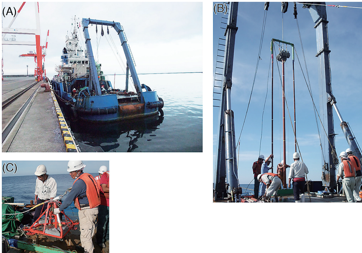
第 1 図 作業船ひろかい (A) とバイプロコアラー (B) およびグラブ採泥器 (C) による採泥の様子。 Fig.1 Photos of R/V Hirokai (A), a vibrocooler (B) and a grab sampler (C) using for the investigation.
