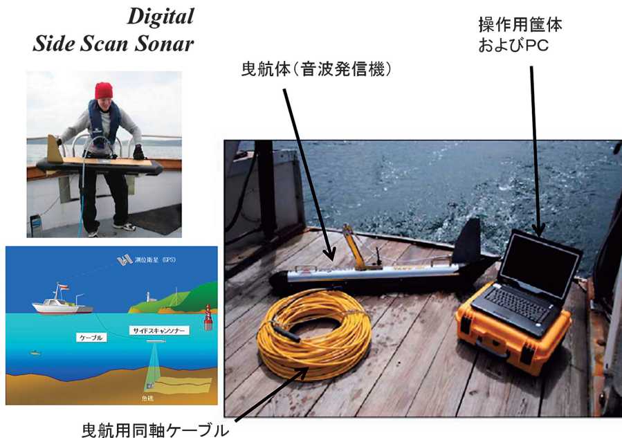
第4図 デジタルサイドスキャンソナー装置。 Fig.4 Acoustic instrument (digital side scan sonar system) used for the survey.
