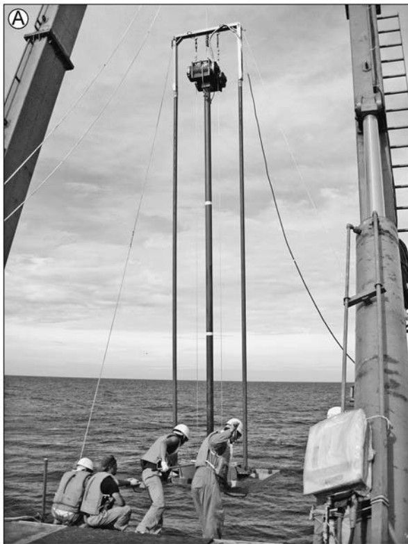
第 2 図 A : 柱状試料の採取に用いたバイプロコアラ。 B : バイプロコアラの先端部.
