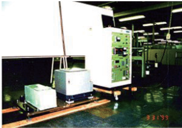
第 2 図 ヘリコプター搭載型重力計 (Airborne Gravimeter Segawa-Tokimec Model FGA-1)。中央が水平安定台と重力センサーの入ったボックス。左が光ファイバージャイロ。右は制御およびデータ記録装置。総重量は 250kg 程度。
