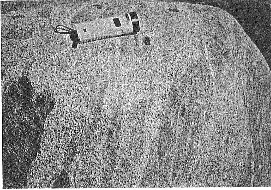
写真6 片状構造が著しい ボンシルトナル岩 (西帯). 帯磁率 5.3-7.1 \times 10^3 SI 単位.
