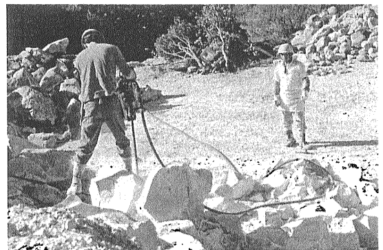
写真5 傳兵衛木場採掘場での選鉱作業。陶石を小割りし、品質毎に選別する。微妙な職人技の世界だ。
