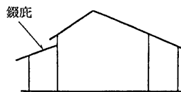
第10図 しころぶ 鍔葺き屋根の和風住宅の解説図(文献19).
