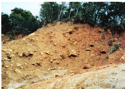
5. 岩盤(A)、亀裂が発達し、褐色を帯びた極めてルーズな安山岩の岩盤。崩壊土砂は、ほとんどがこちらの岩盤からのものと考えられる。
