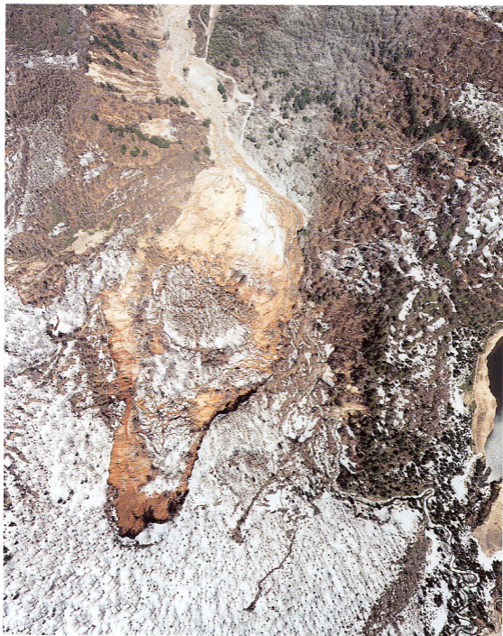
1. 澄川温泉における地すべりとその周辺の様子(垂直写真, 1997年5月12日国際航業株式会社撮影), 中央が地すべりの部分で, 土砂はその上方の谷を流下した。地すべりの前縁下は白色を呈している。また、対岸の樹林帯には帯状に灰色になった降灰範囲が認められる。右下が大沼。
