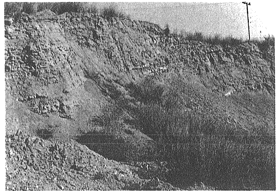
写真3 マエ・モー垂炭田の露天採掘場内にはいたる所に見粘土質の地層が露出するが, それらの多くは泥灰岩である。
