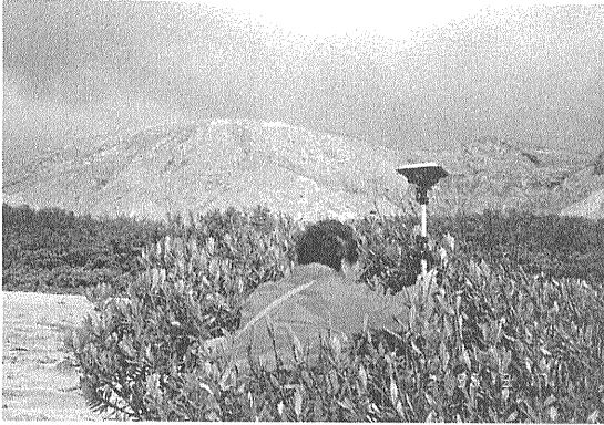
写真6 GPSによる標定点測量。アンテナが強風で飛ばされないようにおさえている。山体の向こう側に主火口がある。
