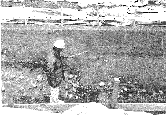
写真2 有馬一高構造線活断層系・真上断層のトレンチ壁面（大阪府茨木市東安威）。写真中央の断層は、西暦1596年の慶長伏見地震の時の活動をあらわしていると推定される。
