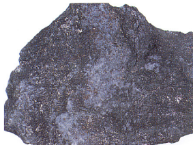
15. 輝碲鉛鉱 (Bismuthinite) : Bi_2S_3 山口県阿武郡旭村佐々並鉱山 花崗閃緑岩中の鉱脈鉱床の石英, 緑泥石中に含まれる。 顕微鏡的に自然碲鉛, アイキン鉱, コサラ鉱, カニツア ロ鉱等を伴う。石英の部分に灰重石を含む。 (GSJ M 13126) ×1
