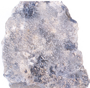
13. 雑銀鉱 (Polybasite) : (Ag,Cu)_{16}Sb_2S_{11} 静岡県田方郡土肥町清越鉱山 浅熱性金銀鉱床の石英脈の空隙に六角板状結晶をなす。 写真石の結晶は輝銀鉱 (針銀鉱), (GSJ M 12361) ×1
