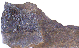
14. 輝安銅鉱 (Chalcocite) : CuSbS_2 愛媛県伊予郡砥部町優量鉱山 含銅層状硫化鉄鉱床を切る脈として産出。輝安銅に似た 柱状結晶をなす。安四面銅鉱を伴う。(GSJ M 12636) ×1
