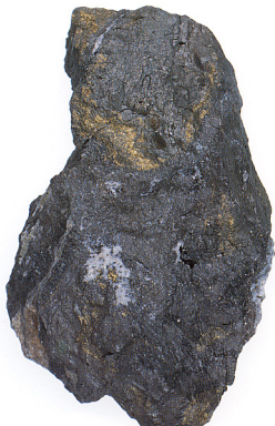
16. 櫻井鉱 (Sakuraiite) : (Cu,Fe,Zn)_3(In,Sn)S_8 兵庫県朝来郡生野町生野鉱山金ヶ瀬鉱床千珠本鍾S 18号 錫, タングステン, 銅, 鉛, 亜鉛等を伴う多金属鉱脈に, 黄銅鉱, 閃亜鉛鉱, 黄銅鉱等とともに細粒緻密な集合を なす。帯緑銅灰色の部分。(GSJ M 12635) ×2/3 〈写真・文 地質標本館 豊 逸秋〉
