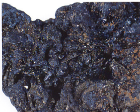
12. セムセイ鉱 (Semseyite) : Pb_9Sb_8S_{21} 埼玉県秩父郡大滝村秩父鉱山大黒鉱床 スカルン鉱床の方鉛鉱, 閃亜鉛鉱に富む鉱石の空隙に, 板状結晶の放射状集合として産する。黄鉄鉱と共生する。 (GSJ M 13227) ×1
