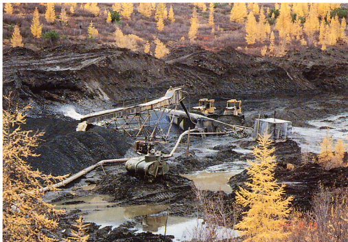
2. ブルドーザ2台を使って高品位部を集め、粗礫を取り除いて比重選鉱にかける。
