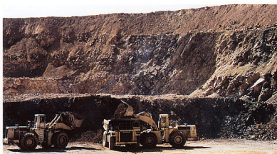
10, Globe Hill 鉛床の大規模な採掘風景。鉛石は熱水変質を受けた角礫パイプに含まれ (Au 1-3 g/t), 地表部では酸化され, 金は自然金の状態で産する。
