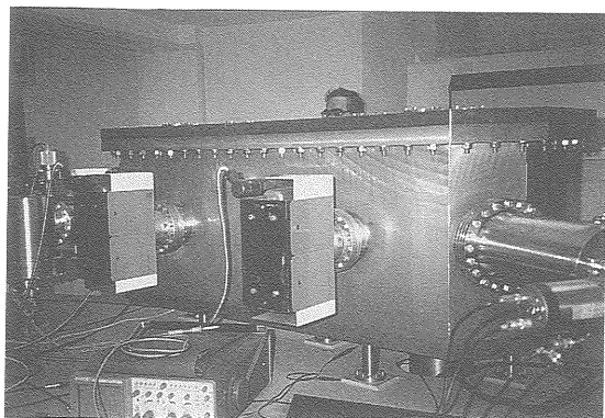
写真4 Cambridge 大学 Isolab 120 の2nd ESA(静電場セクター)。巨大なESA(O'Nions 教授の頭と比較されたい)の真空を確保するため、手前に60 l/sのイオンポンプが2つ取付けてあり、右底面には260 l/sのイオンポンプへ向かう太い管が見える。右端にある二次電子増倍管で 10 Beを測定する。
