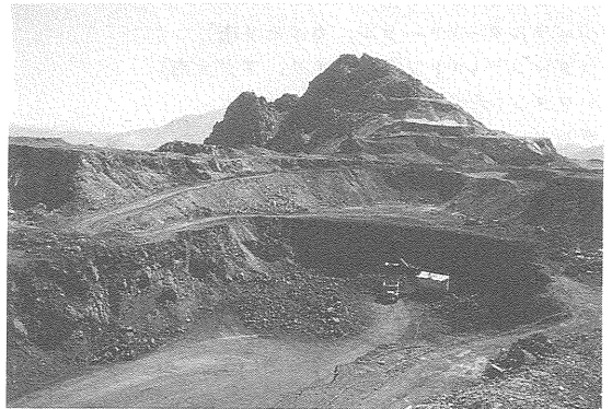
写真1 ディブレイ A 鉱体(シワス市)鉄鉱床. 石灰岩・花崗閃緑岩およびはんれい岩の接触部に産する.
