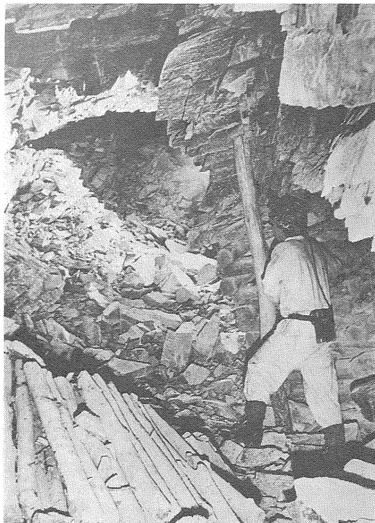
写真1 南アフリカの鉱山(深度3150m)で生じた「山はね」 (Gay and Wainwright, 1984)
