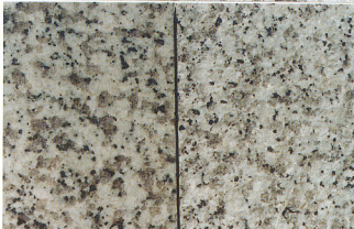
4. 表面仕上げの違いによる質感の差：本磨き(左)およびバーナー(右)。 (上)、ポルトガル産のシェニトモンチーク=霞石閃長岩 (下)、稲田花崗岩
