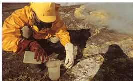
9. NaOH溶液を入れ排気したガラスびんにチタン製のパイプを通して火山ガスを採取し、主成分・微量成分の含有量やO(酸素)・H(水素)などの同位体比を測定する。
