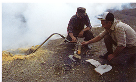
10. 共同研究相手のソ連チーム(リーダー=I. Menyailov)のガス採取風景。Cdを含むNaOH溶液にガスを通して、 H_2S をCdS(黄色い沈殿物)として回収する。1988年2月
