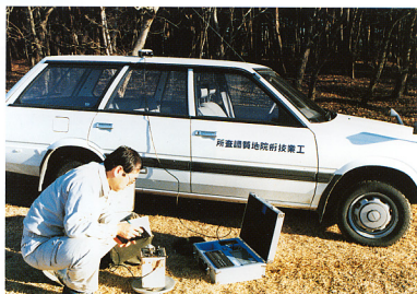
写真2 GPSを用いての重力調査車の屋根上に見える小さく白い片がGPSのアンテナ。本体はアタッシュケースにすべて組込まれている。
