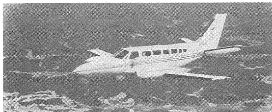
写真 4 磁気探査用スティンガーを装備したセスナ 404 型探査機。
